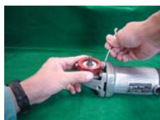
②カバー固定用 リングを取付けます
