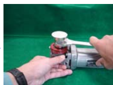
③専用研削刃を 取付けます
