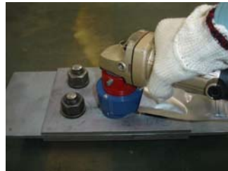
グラインダを押しつけ研削刃で研削します
