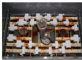
腐食促進試験 (日本塗料検査協会サイクル)
