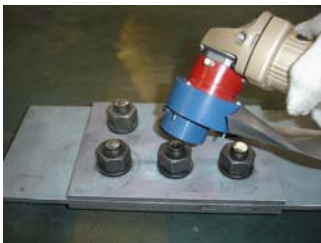
ボルトに飛散防止カバーをかぶせます
