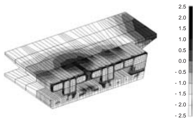
図7 コンクリート部材の軸方向応力度
