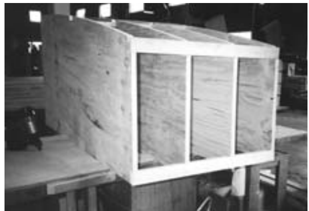
写真2 くし板を組み立てた箱型
