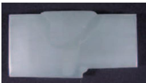
写真1 溶接部断面形状（マクロ試験片）
