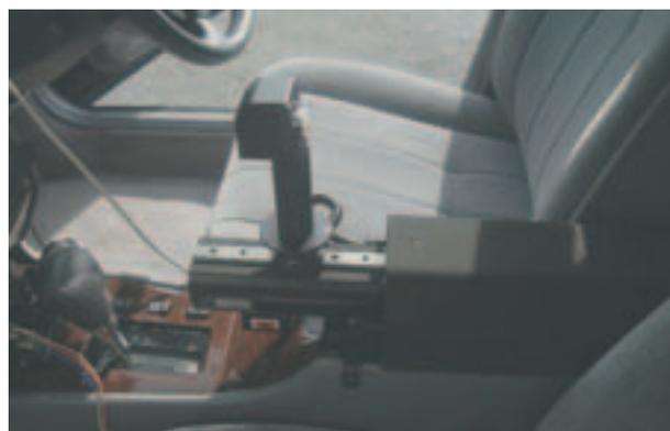
試験車内に2軸反力制御付きジョイスティックを取り付けた様子
