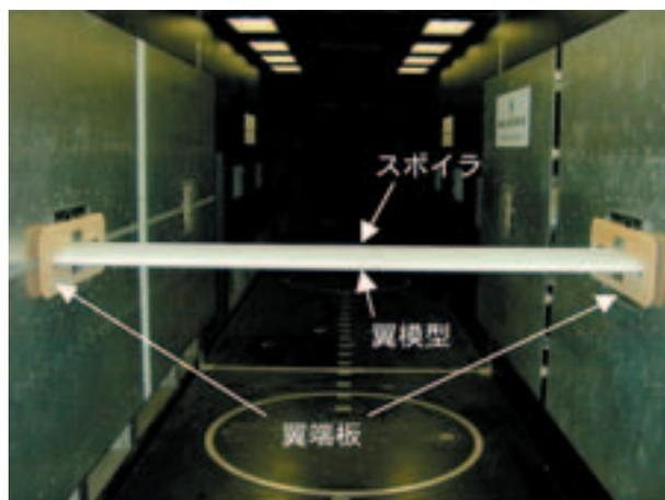
風洞内に設置した2次元翼模型とスポイラの正面の様子
