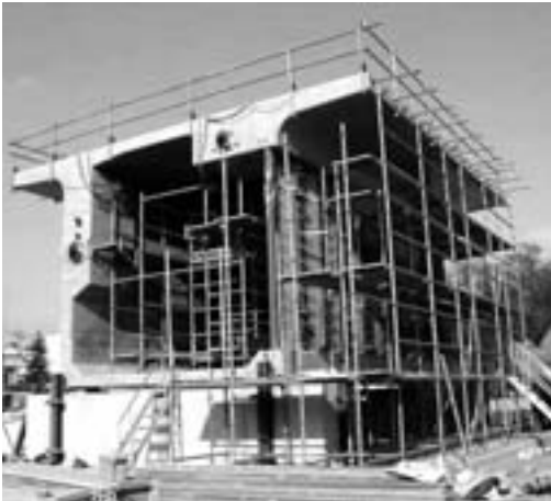
写真2 定着突起部試験体
