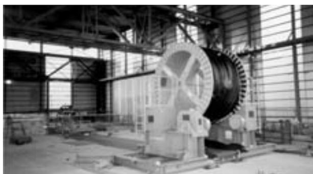
写真3 アンリローラーによる展開挿入
