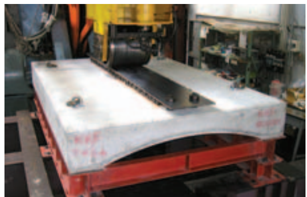
載荷試験状況
