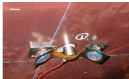
写真2 AEセンサーの設置状況
