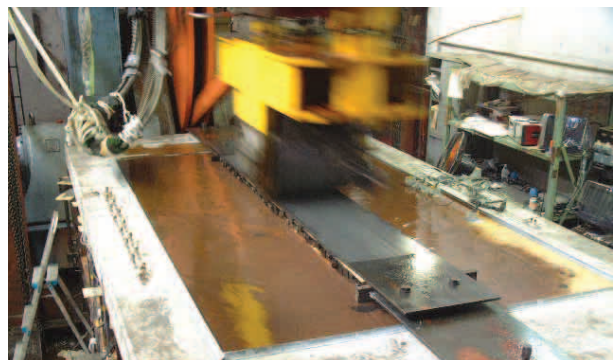
写真2 輪荷重走行試験状況（水張り走行試験状況）
