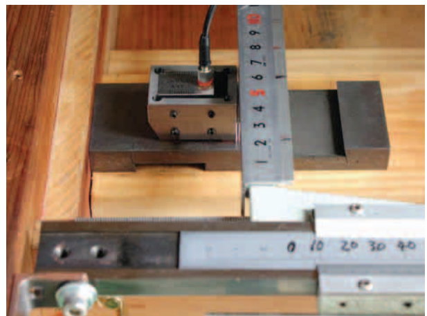
図3 スリットきずの測定状況
