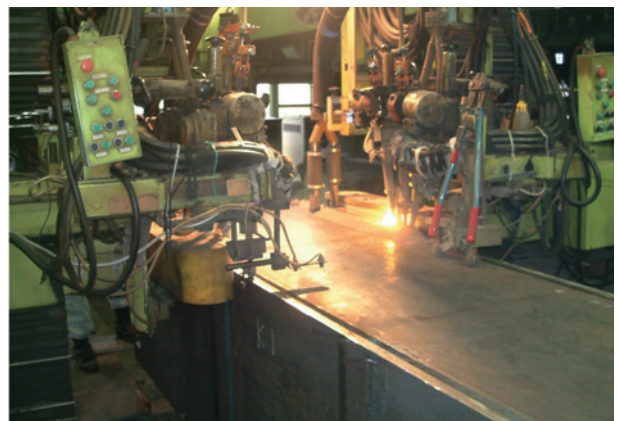
写真3 角溶接（サブマージアーク溶接）
