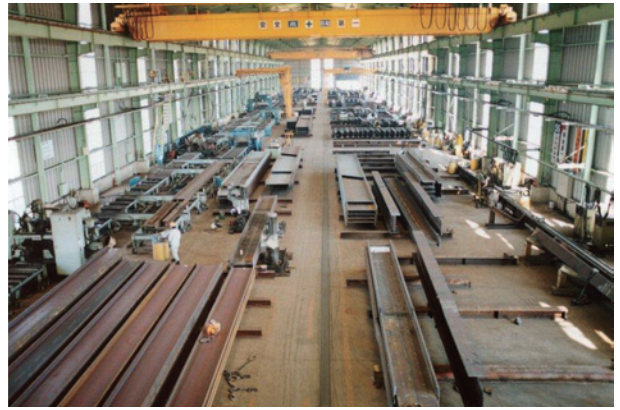
写真5 栃木第二工場大梁加工ライン
