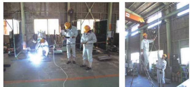
CO 2 濃度計測作業
