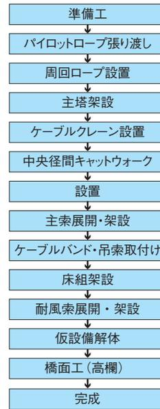
図7 上部工架設フローチャート
