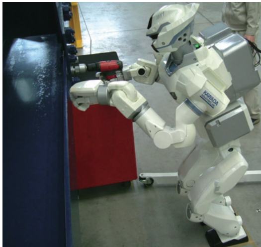
写真6 電動ドライバを使った作業
