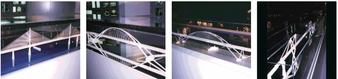
写真6 オレスン海峡大橋計画段階の代替案模型
