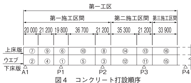
図4 コンクリート打設順序
