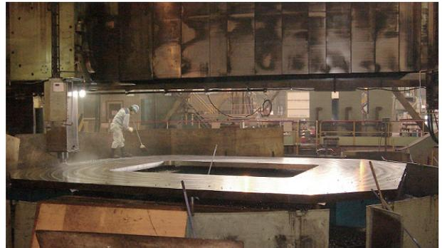
写真1 底板切削状況
