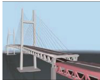
②桁端変位による隣接橋梁押し出し
