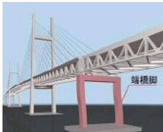
①端橋脚の耐力不足
