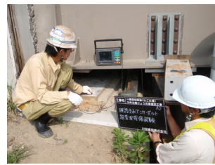
写真11 アンカーボルト健全試験状況
