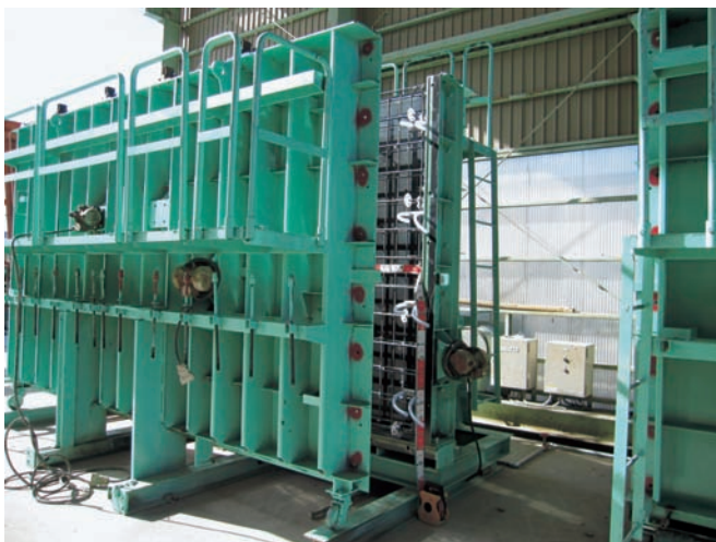
写真1 縦打鋼製型枠
