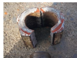
切断されたナットの状況
