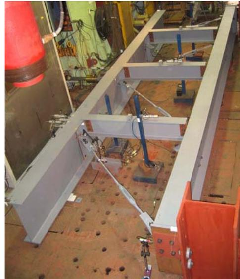
写真3 偏心接合した屋根ブレース構面の試験
