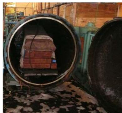
防腐・防蟻処理用加圧釜の内部
