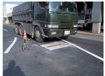
写真7 KMSジョイントの試験状況
