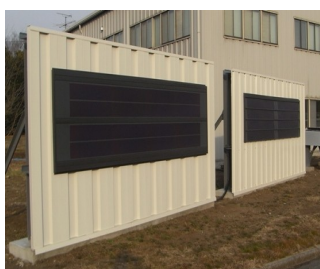
図3 システム建築壁面へのソーラー設置実験 (栃木県芳賀町)
