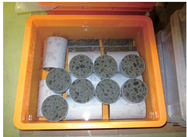
写真2 塩化セシウム水溶液への浸せき中の試験体
