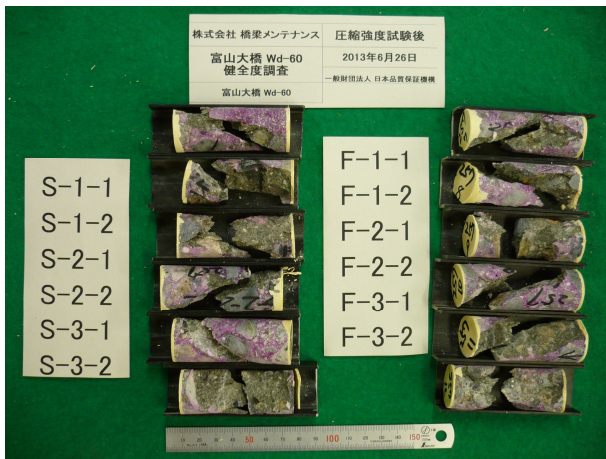
写真7 試験後のテストピース
