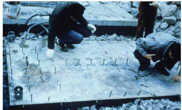
写真1 スタッド破断状況
