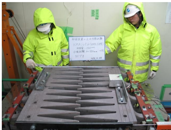
写真 14 引張試験状況
