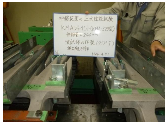
写真 7 試験体接続前（タイプ 1）
