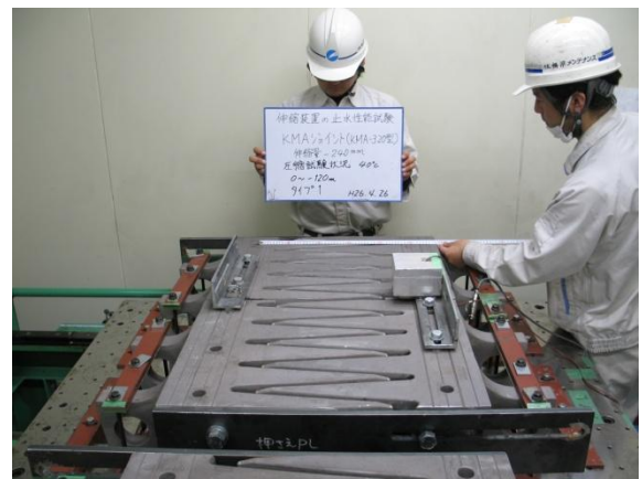
写真12 圧縮試験状況
