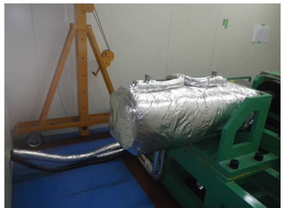
写真 5 油圧ジャッキの断熱対策
