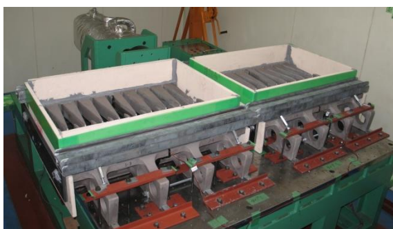
写真 16 型枠設置完了
