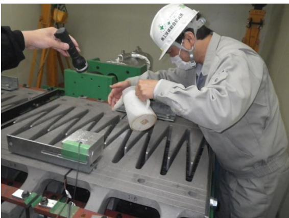
写真11 連続試験時の簡易水張り試験状況
