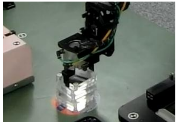
図4 エアチャックの開閉を利用したワークの把持
