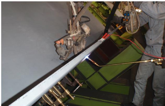
写真1 SAW中の同時裏面加熱状況
