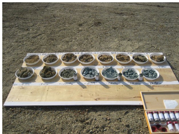
写真2 支持層の確認
