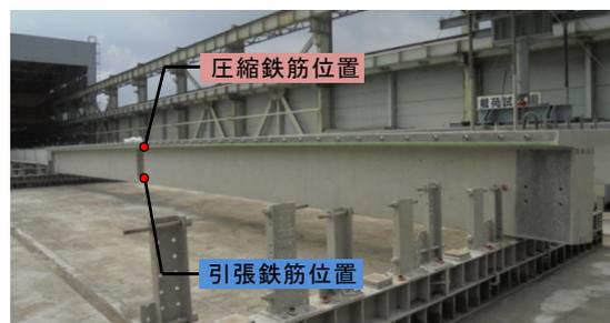
写真 1 試験桁の鉄筋ひずみ計測位置 (支間中央部)
