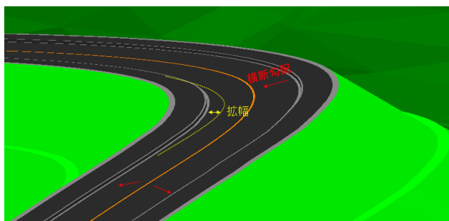
図2 設計規格に準拠した拡幅・横断勾配の自動設定
