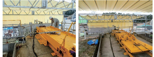
(a) 中央部衝突試験 (b) 端部衝突試験 写真6 PCa壁高欄の衝突試験の実施状況
