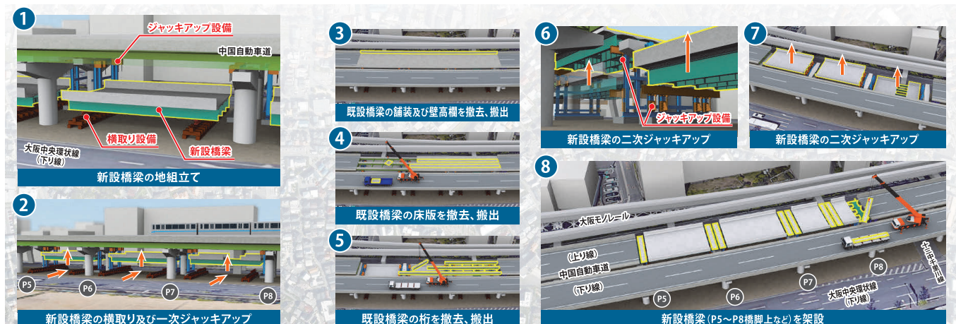
図 4 ジャッキアップ工法の概要
