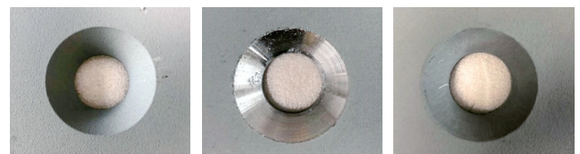
(a) 無機ジंक (b) 無塗装 (c) 有機ジंक 写真8 連結板ざぐり部の表面処理仕様
