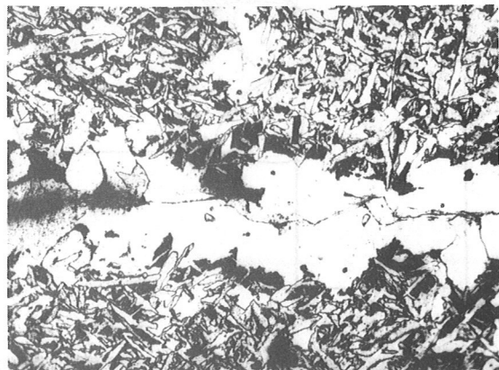
写真-5 エレクトロスラグ溶着金属部に発生した割れ。(×120)
