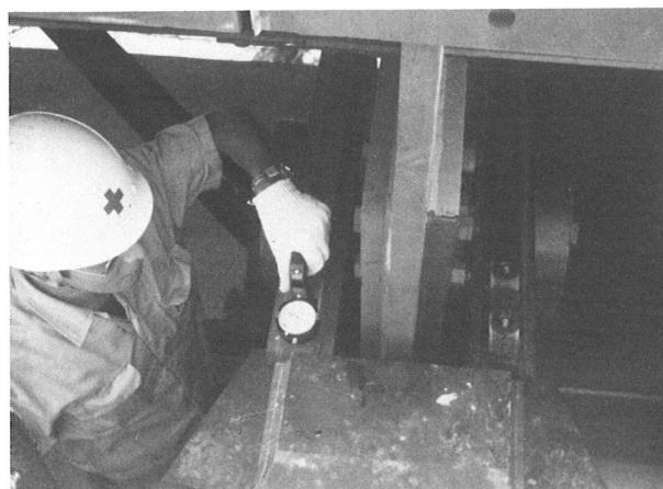
写真-23 水平反力測定
