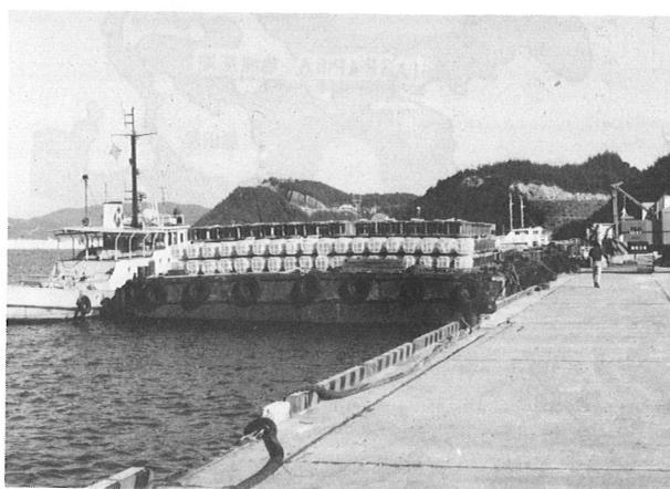
写真-2 部材水切場にバージで搬入されたフレーム部材
