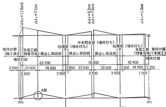
図-16 施工誤差図（上段一張出し架設完了時、下段一場所打ちコンクリート施工時）
