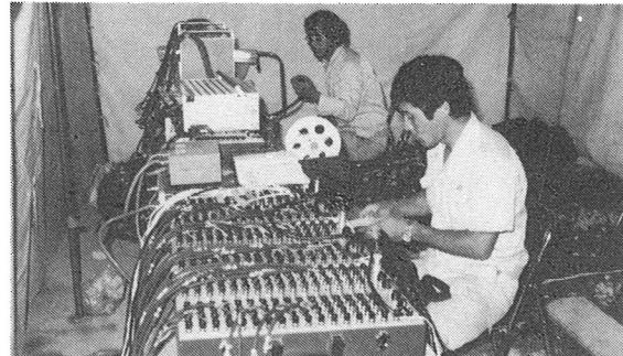
写真-8 載荷試験振動・応力測定風景
