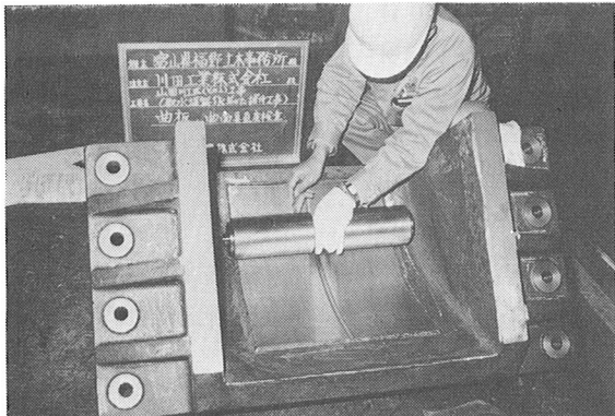
写真-3 支承曲板 (SCW49+ステンレス肉盛り)
