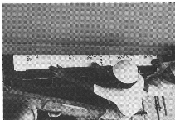
写真-6 プレスケールによる反力分布の測定
