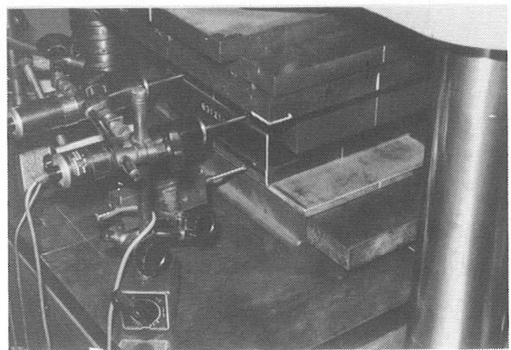
写真-12 せん断変形の測定状況
