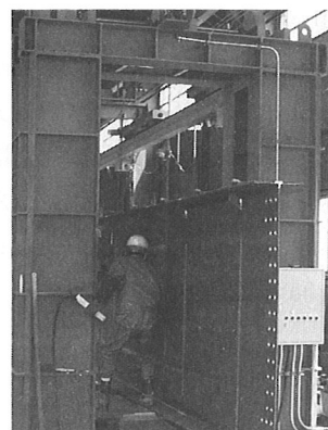
写真-2 油圧プレスによる歪矯正
