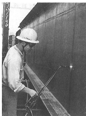
写真-1 線状加熱による歪矯正
