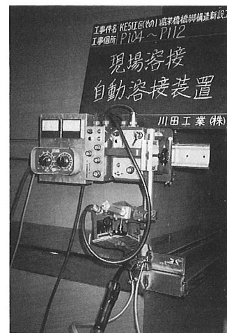
写真-2 溶接装置
