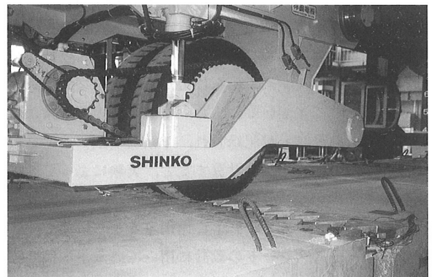
写真-3 輪荷重移動載荷試験
