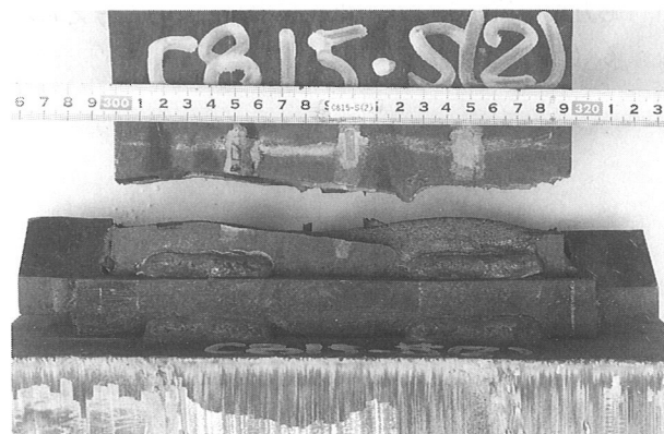
写真-6 破断状況 (C815-S2)
