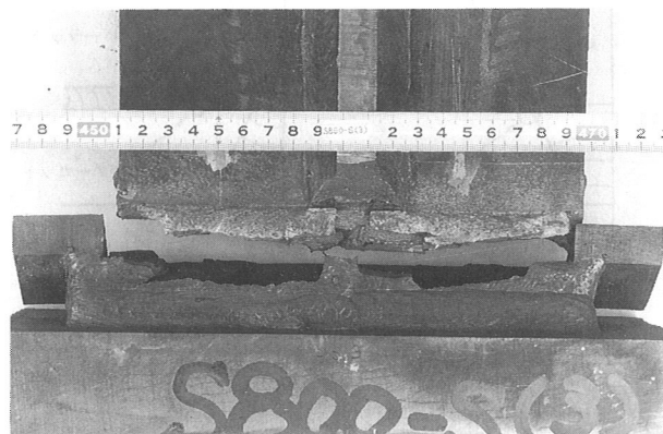
写真-5 破断状況 (S800-S3)
