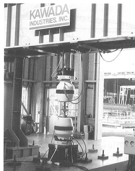
写真-1 載荷フレームとアクチュエータ
