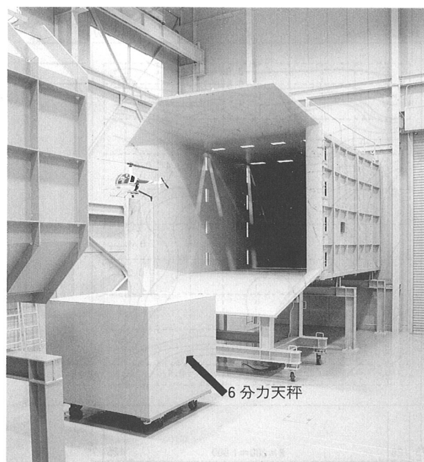
写真-4 航空実験用開放型測定洞
